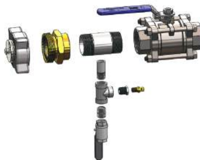
PROCESO ACTUAL DE ENSAMBLE DE PURGA
