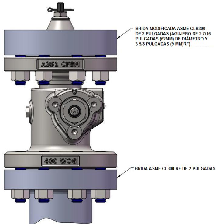
**FIGURA 2: DIAGRAMA DE UNA INSTALACIÓN TÍPICA DE VÁLVULA ME990-2DFN**
