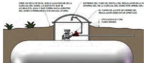
Figura 5: Instalación subterránea
