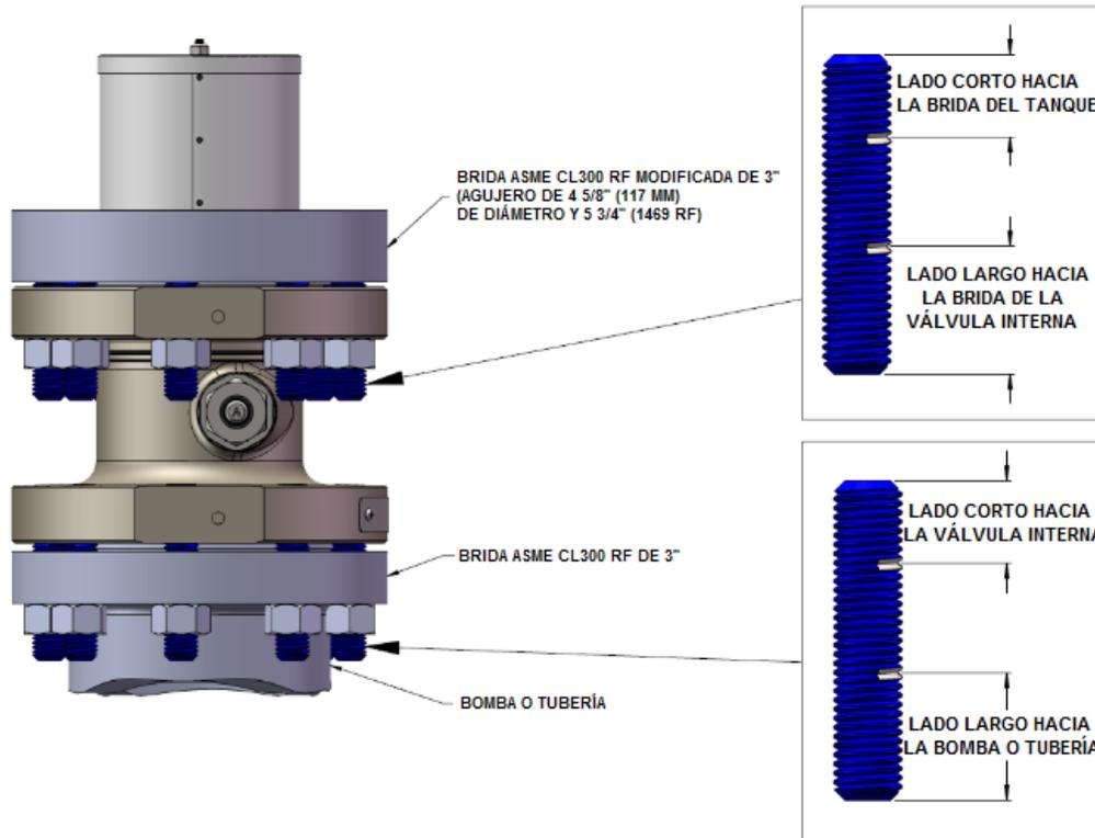
**FIGURA 2: DIAGRAMA DE UNA INSTALACIÓN TÍPICA DE VÁLVULA ME990-3DF**
